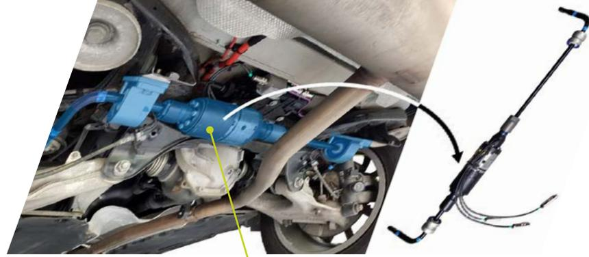
Stabilizzatore adattivo (installata sull'asse posteriore del veicolo)
